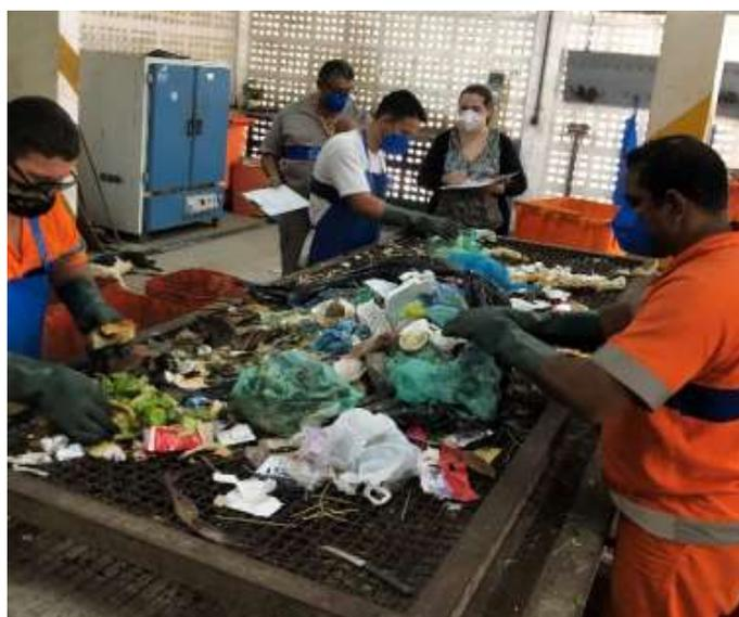
**Figura 5** - Triagem dos RDO na mesa de separação.
