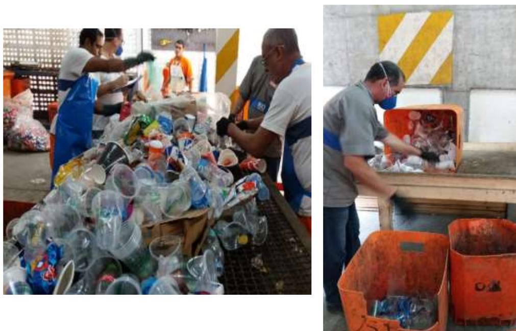
**Figura 8** - Separação e inspeção visual para classificação dos plásticos
